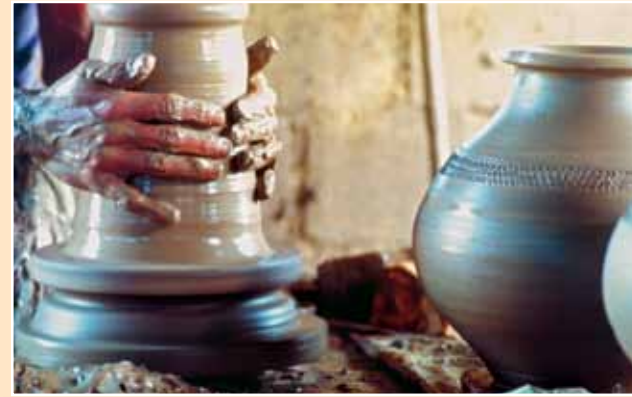
Torno, instrumento essencial para a modelagem das peças de barro.
